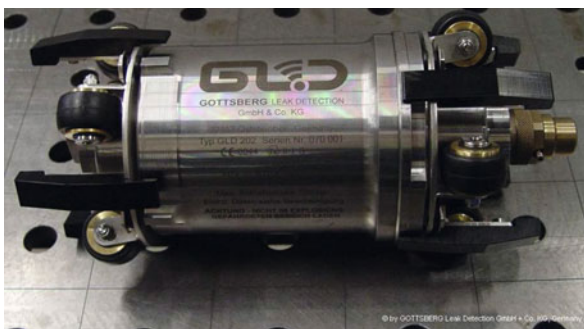
Bild 2. GLD 202 Leckdetektor mit GLD 302 Fahrge-stell NW 200 mm.
